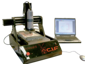
CNC frézka na výrobu DPS. Další využití je frézování plastu a hliníku
