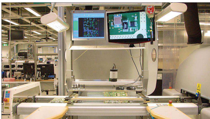
Sprážený stojan XY s velkou pracovní plochou. Kamera umístěná nad dopravníkem po osazení součástky.
