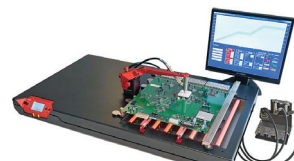
Oprávné pracoviště EXPERT 04.6-HXH ■ Rework stanice s 5 000W hybridním spodním ohřevem, nastavitelná velikost ohřevné plochy až 450 × 420 mm 2 . Funkce SHP (Single Head placer), software Easy-Solder ECO.
