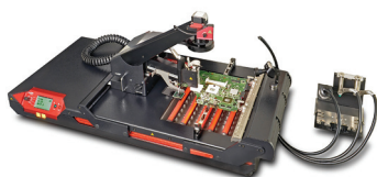
Oprávné pracoviště EXPERT 10.6 HV ■ Rework stanice s 3 000W hybridním spodním ohřevem, nastavitelná velikost ohřevné plochy až 275 × 245 mm 2 . Funkce AVP (Auto Vision Placer), software Easy-Solder.
